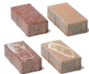
Ukázka povrchu bez a ukázka s cemento-vápenným výkvvětem.
